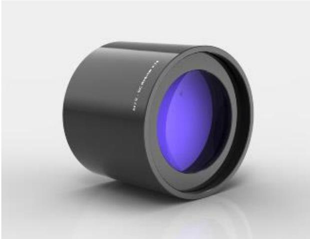
Der für f/8,0 RC-Teleskope berechnete 4 Zoll Alluna Flat Field Reducer .74x (AFFR) erfüllt zwei Aufgaben. Zum einen korrigiert er das Bildfeld und gleichzeitig verringert er die Brennweite um den Faktor x0.74. Aus einem f/8,0 RC wird somit ein f/6,0 System. Das Bild ist eben, frei von Koma und Astigmatismus. Der Reducer kann an allen f/8,0 RC-Systemen benutzt werden.
