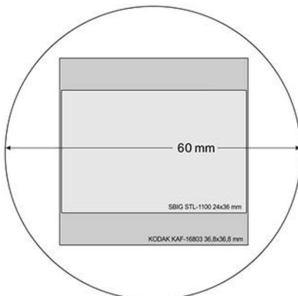
Mit dem Reducer AFFR .74x kann der Kodak KAF-16803 4x4k CCD-Sensor mit einer Diagonalen von 52.1 mm vignettierungsfrei benutzt werden.
